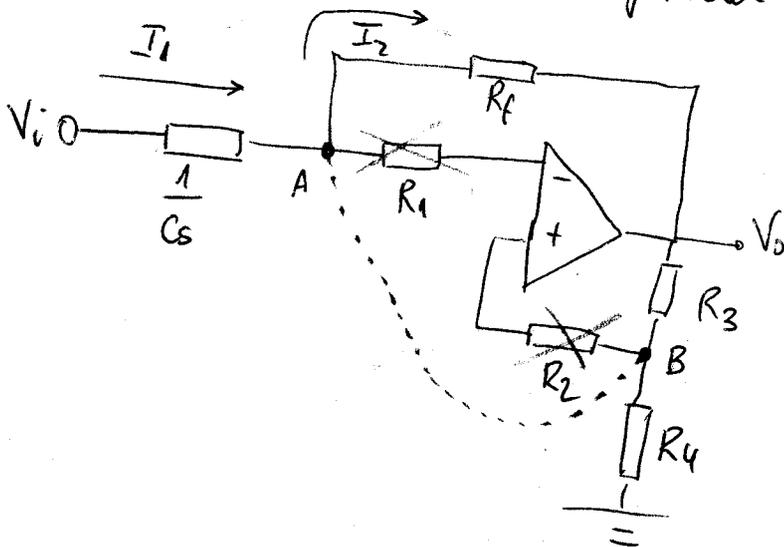
Por las ramas de  $R_1$  y  $R_2$  no circula corriente por ser las que entran en los pines del amplificador. Además, aplicando la hipótesis del cortocircuito virtual,  $V_A = V_B$ .
