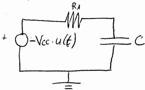
donde las condiciones iniciales no son nulas, porque entre las placas del condensador existe una tensión inicial  $+V_{cc}/2$ . Esto hay que tenerlo en cuenta
