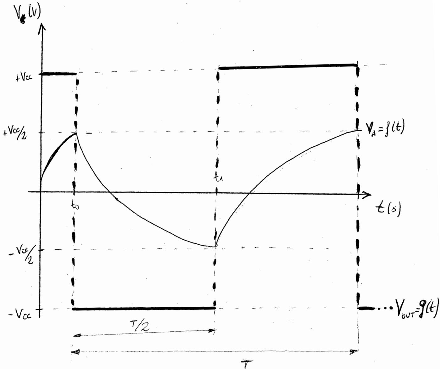
Resta ahora calcular el período  $T$  de la señal cuadrada que obtenemos en la salida del amplificador. Como se aprecia, es el doble del tiempo que tarda el condensador en cargarse de  $V_{cc}/2$  a  $-V_{cc}/2$  (mejor dicho, el que transcurre desde que entre
