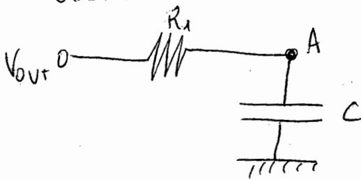
$V_{out}$  es una señal constante en el tiempo (es decir, estamos en condiciones de corriente continua), así que por el condensador no debería circular corriente. Esto
