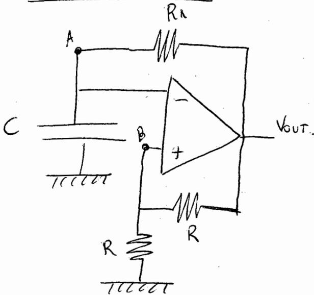
Tenemos que considerar que el amplificador operacional está funcionando en realimentación positiva. Debido a su inestabilidad,  $V_{out}$ , en principio, será, o bien  $+V_{cc}$  (tensión de saturación del amplificador), o bien  $-V_{cc}$ .
