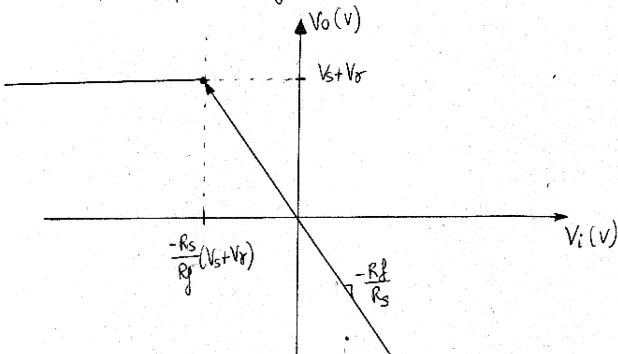
Podemos comprobar que es correcto viendo que no hay discontinuidad:  $V_o(1^{\text{er}} \text{ tramo}) \Big|_{\text{desalto}} = V_o(2^{\text{do}} \text{ tramo}) \Big|_{V_i = -\frac{R_s}{R_f}(V_r + V_s)}$
