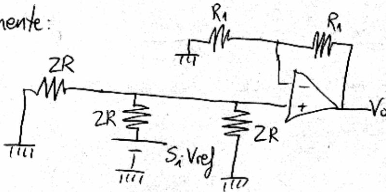
De nuevo las dos resistencias de valor  $2R$  de la izquierda del todo y de la derecha del todo están en paralelo, con lo que queda una resistencia de valor  $R$ . Así, en la parte inferior tenemos el siguiente divisor de tensión.
