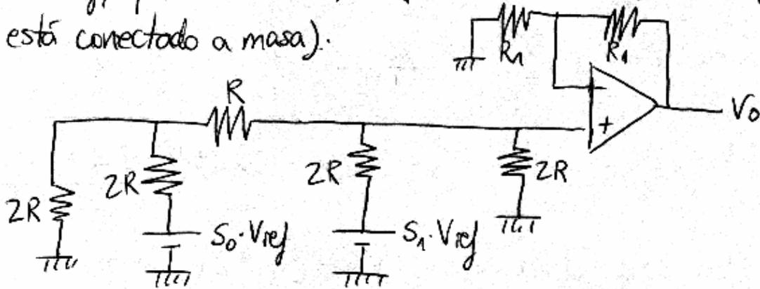
Por superposición: anulamos la fuente  $S_0 \cdot V_{ref}$ , con lo que las dos resistencias de valor  $2R$  que hay a la izquierda están en paralelo:  $2R \parallel 2R = \frac{4R^2}{4R} = R$ . Y el resultado de la asociación está en serie con la resistencia de valor  $R$ :  $R + R = 2R$ . Finalmente:
