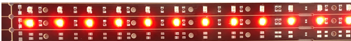
Figura 14: Tira de LEDs funcionando con una alimentación de 12 V
