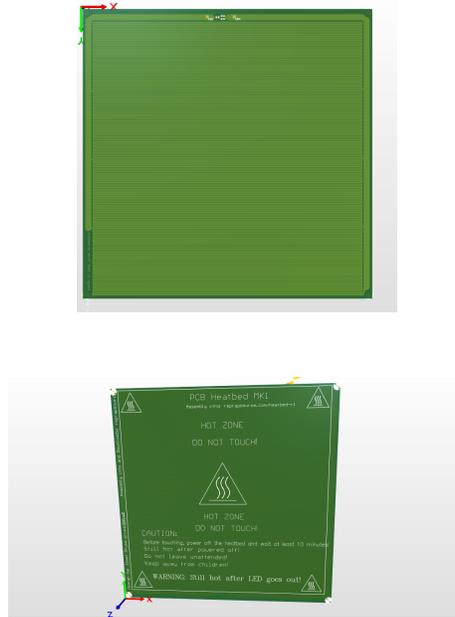
Analizando dicha PCB se puede observar como la estructura está formada por dos diodos en antiparalelo seguido de las pistas que actúan como resistencias Y el esquema que define dicha figura es el siguiente:
