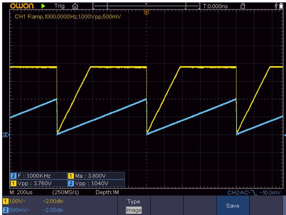
Figura 8: Amplificador con  $R_L$ . La línea azul es la señal de entrada y la amarilla es la señal de salida
