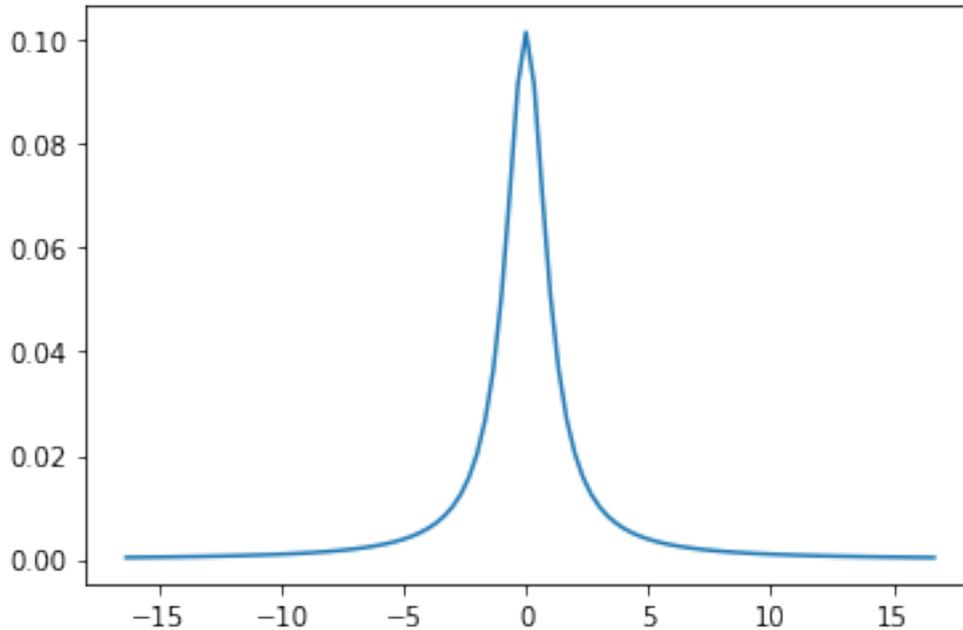
La corriente arriba es  $I_0$ ,  $I(x)$  es la corriente de vuelta (la que va por el plano de masa) Queremos calcular el ancho del plano inferior que ocupa la corriente, cuando la corriente de abajo es igual al 95% de la corriente de arriba.
