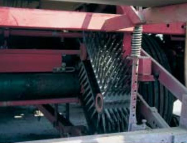
En tal caso el sistema de siembra no consiste en cangilones, sino, por ejemplo, en una correa en forma de canalón. Con este sistema, las patatas se colocan en una línea continua sobre las correas de siembra para garantizar una distancia adecuada en el surco.
