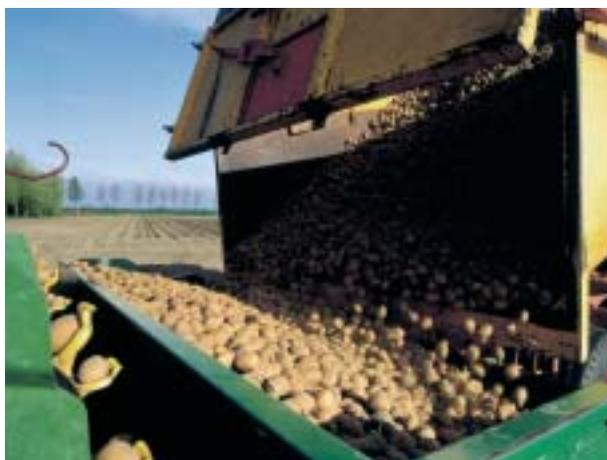
Los cangilones recogen la patata de siembra de la tolva, la llevan hacia abajo detrás de la reja que abre el surco y la dejan caer a la distancia requerida en el surco. Dos discos ajustables o aporcadores situados en la parte trasera de la máquina cubren finalmente los tubérculos sembrados.
