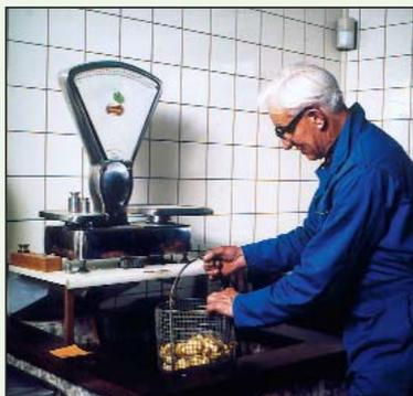
*La determinación del peso de una muestra de patatas en agua*
