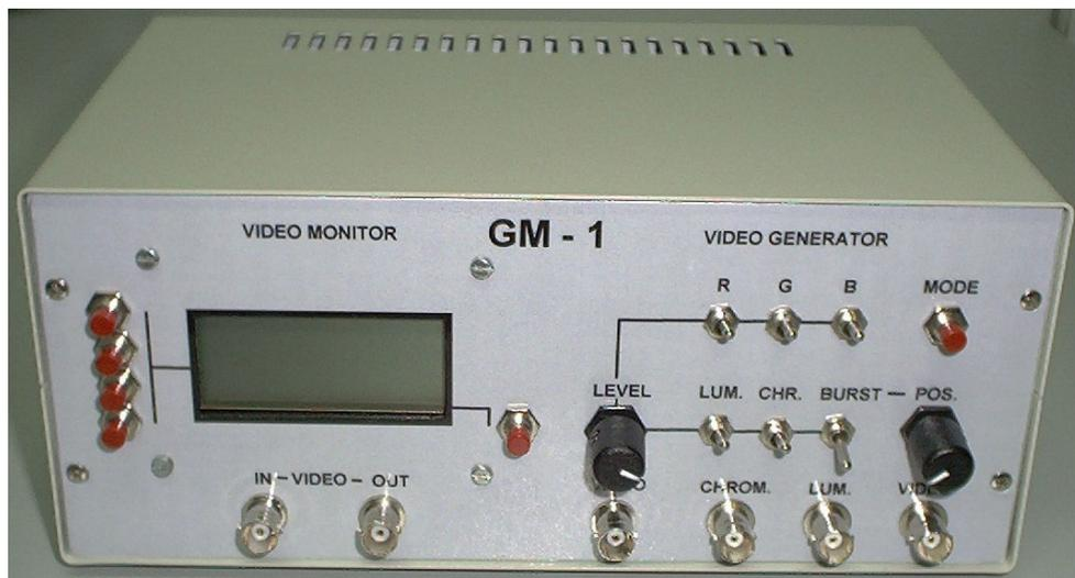
**Figura 1** – Vista exterior del Generador–Monitor de Video para TV.
