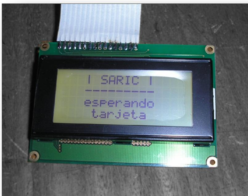
Figura 6.36: LCD conectado a uno de los dispositivos
