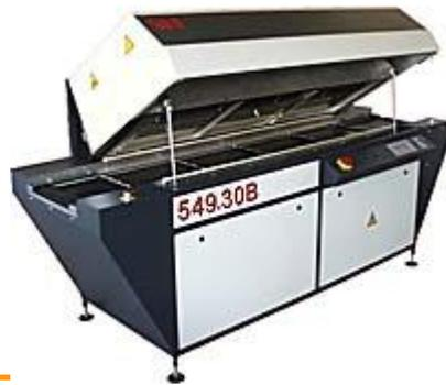
Este método resuelve los problemas del infrared reflow soldering y consigue una distribución de temperaturas mejor.
